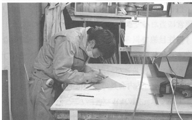
自社工場では部材をプレカットすることで、工期短縮が短縮されるだけでなく、施工現場での騒音も軽減され、お施主様からも「静かでいいね」と好評。
